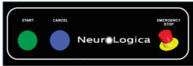
Figura 241: Painel de controle do escâner — botão START
