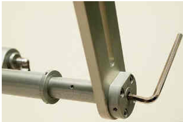
Figura 359: Ajuste da bancada do DORO com a chave Allen
