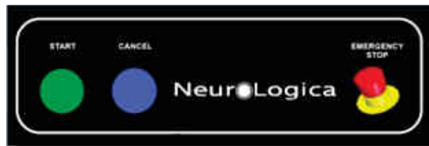
Figura 8: Vista ampliada do painel de controle do escâner e do botão de E-STOP
