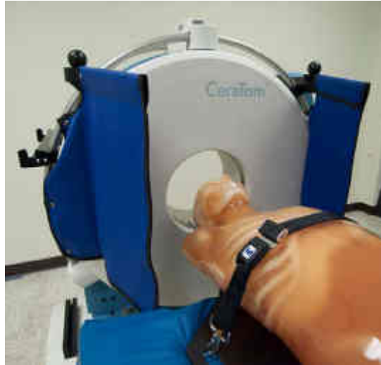
Figura 376: Simulador na placa de transferência universal, cinta de segurança no lugar
