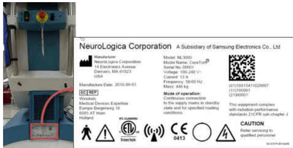
Figura 9: Placa de identificação do produto na lateral do escâner
