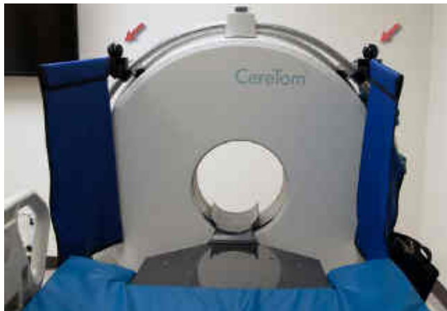
Figura 50: Cortinas de blindagem posicionadas com botões
