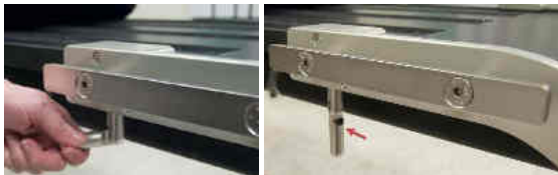
Figura 397: Trilhos de fixação do Doro (duas vistas)
