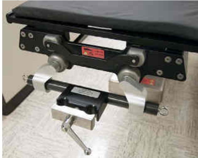
Figura 392: Adaptador de mesa de OR acoplado ao suporte de montagem
