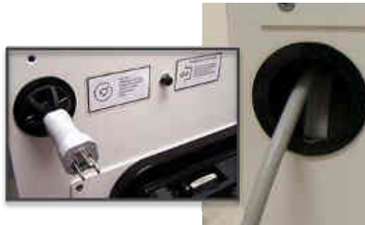
Figura 409: Cabo de alimentação retrátil do SDS retraído (esquerda) e não retraído (direita)
