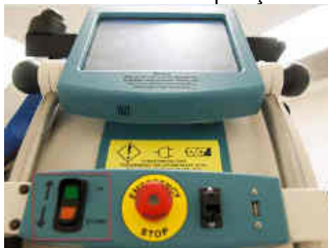
Figura 414: Botões Para cima e Para baixo do interruptor basculante
