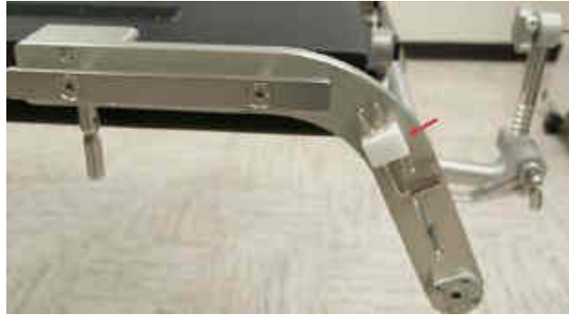
Figura 394: Ajuste da bancada do Doro usando a chave Allen
