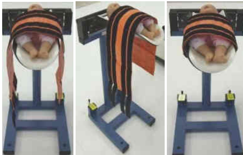
Figura 385: Colocação da cinta pediátrica na plataforma (três vistas)
