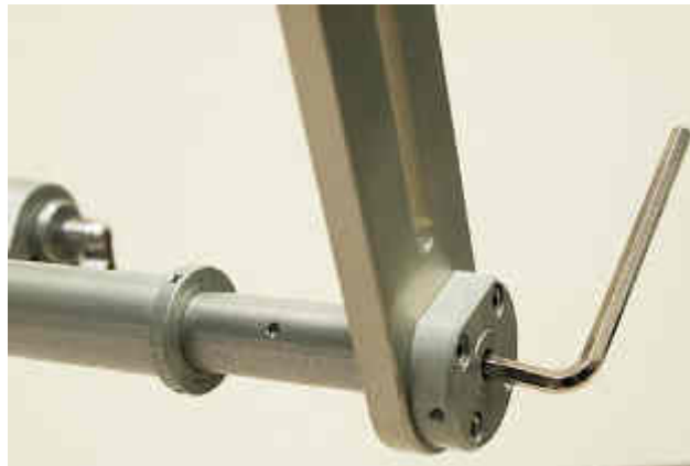
Figura 395: Ajuste da bancada do Doro com a chave Allen
