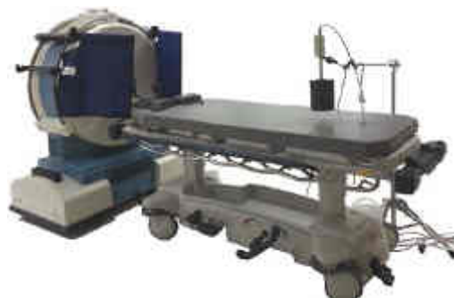
Figura 221: Configuração do sistema para medições de dispersão
