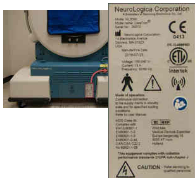
Figura 4: Placa de identificação do produto na parte traseira do escâner
