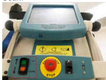
Figura 40: Botões Para cima e Para baixo do interruptor basculante
