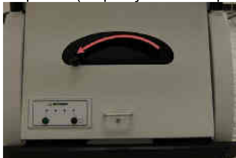
Figura 413: Alavanca de bloqueio na posição desbloqueada
