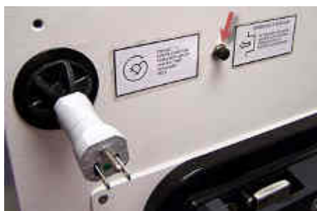
Figura 410: Desbloqueio de emergência pneumático do SDS
